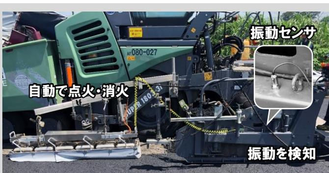
スクリーンに取り付けられた振動センサが、走行時のタンバやバイブレータの振動を検知し、信号を出力。
