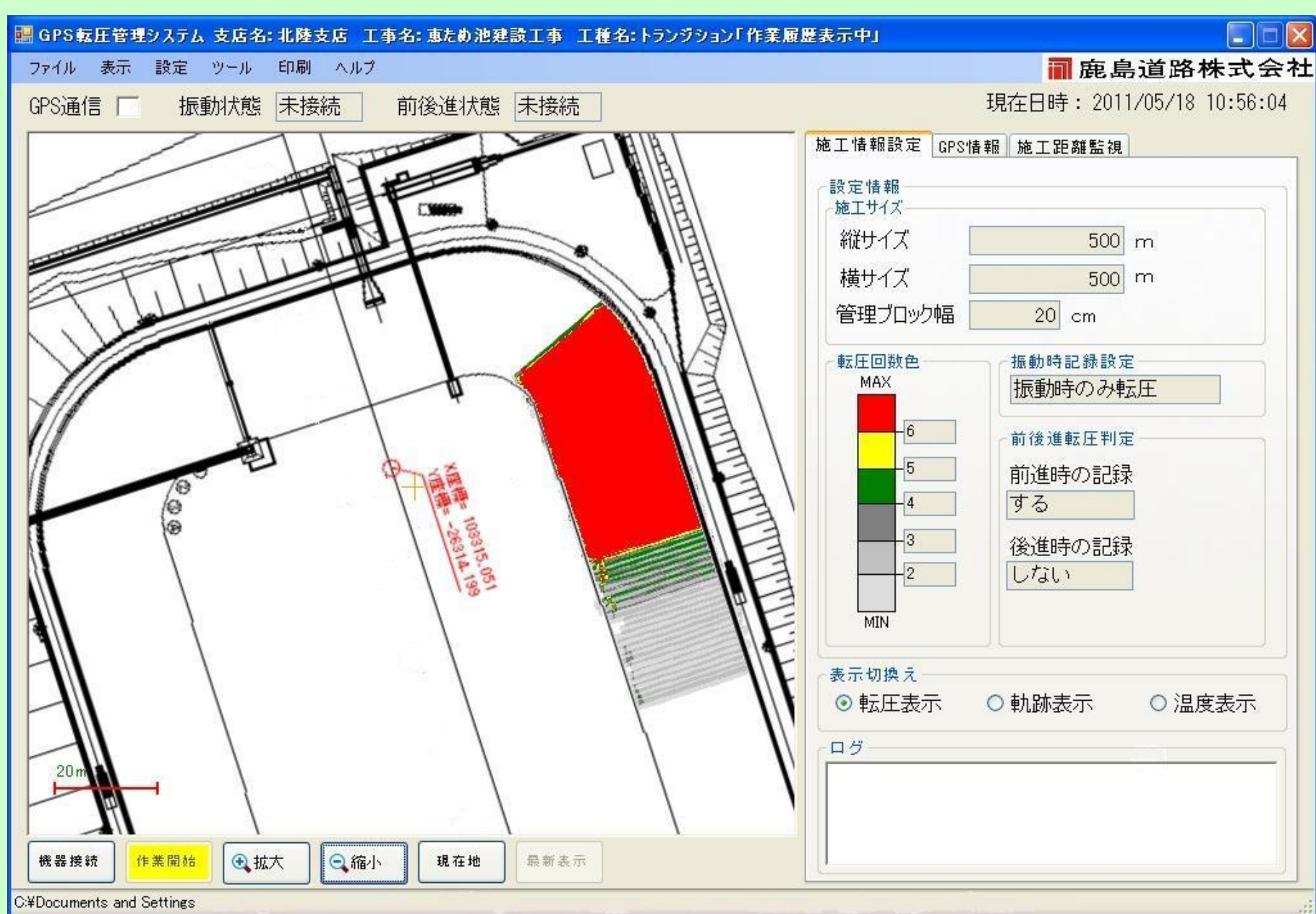
車載PC 転圧管理表示画面(例)
