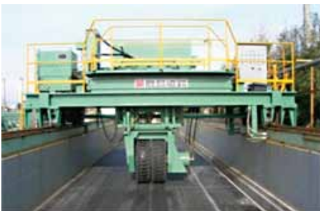
舗設直後の輪荷重走行試験の様子と試験条件
