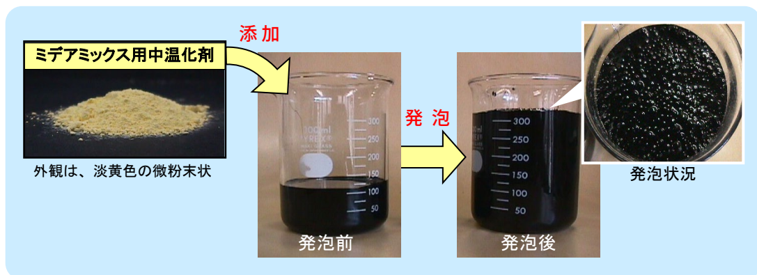
中温化剤添加によるアスファルトの発泡状況
