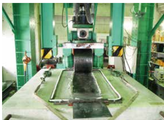
動的評価(輪荷重走行試験:日本大学生産工学部)
