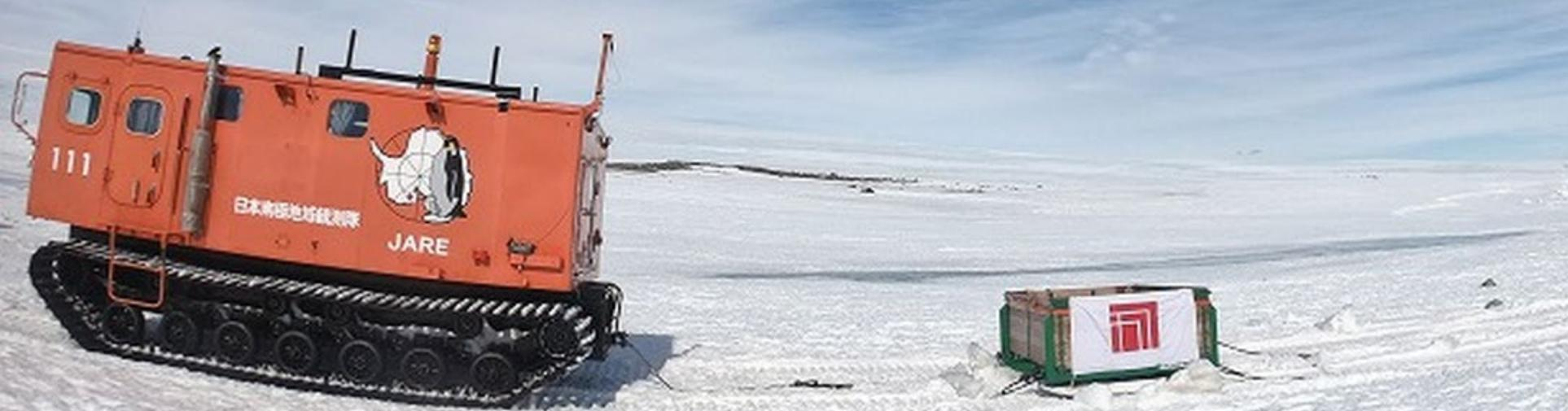
気温マイナス90℃近くに及ぶ極寒地南極大陸において、観測活動を支えているのが南極観測用雪上車です。南極の越冬期間における唯一の陸上移送手段として重要な装備である雪上車は、ボルト1本に至るまで耐寒性、信頼性を突き詰めた極地技術の塊です。写真は大原鉄工所：SM100S型雪上車。
